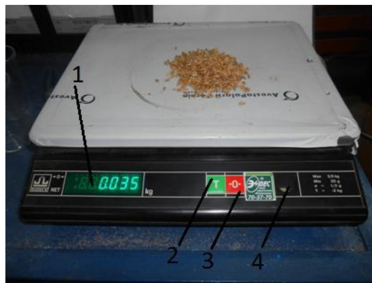
Рис. 2.1 Ваги електронні ПВ-6: 1 – дисплей; 2 - скидання показань маси тари та компенсація маси тари на індикаторах маси; 3 – корекція навантажених ваг; 4 - ампула рівня
