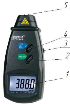
Рис. 2.4. Тахометр цифровий: 1 – дисплей; 2 – кнопка підтвердження дій; 3 – кнопка «Вимірювання»; 4 – перемикач режиму; 5 - світловий промінь
