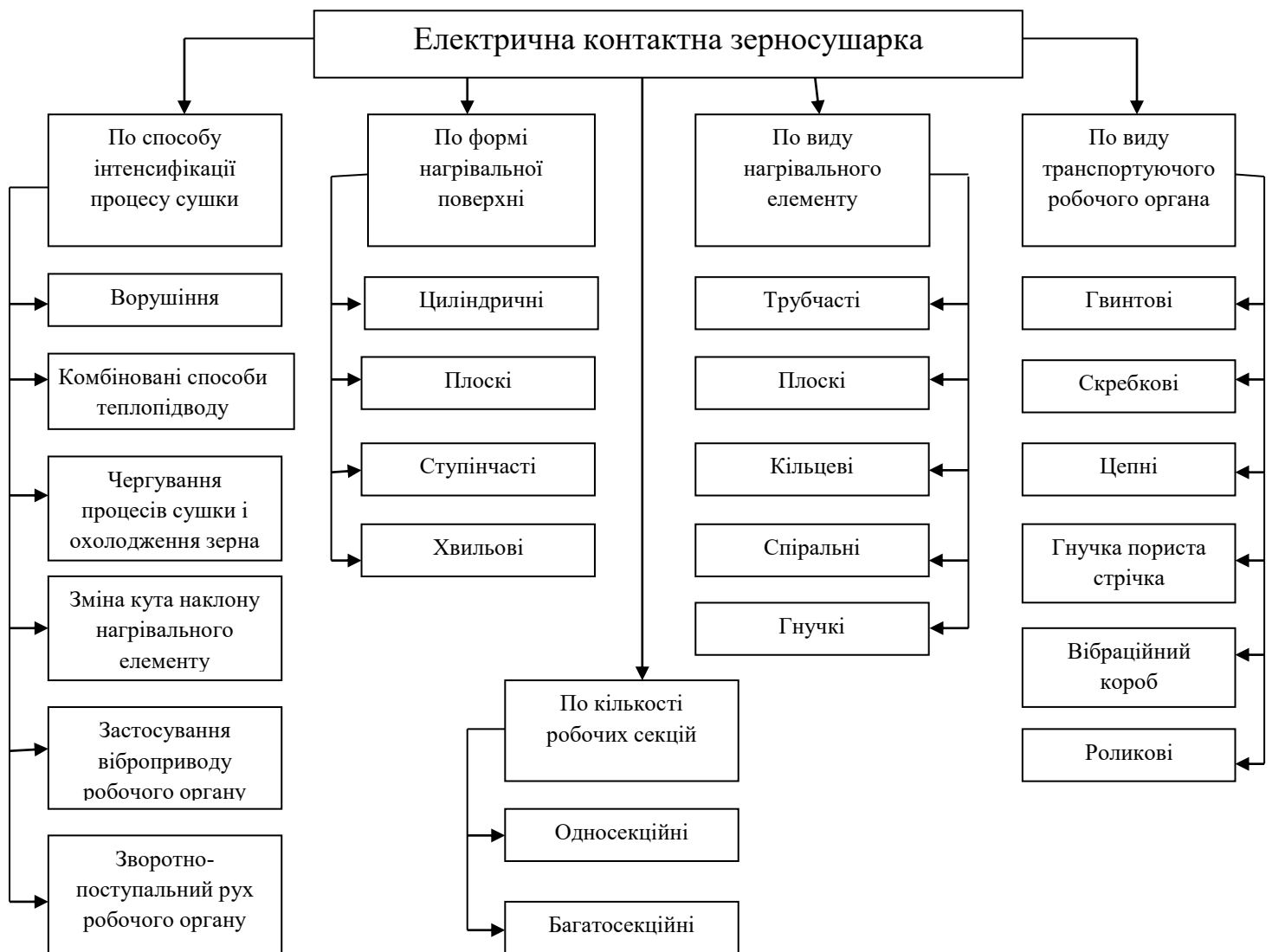
Рис.1.1 Класифікація контактних зерносушарок
