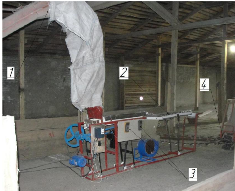
Рис. 3.7. Технологічна лінія підробітку зерна: 1 – зернонавантажувач ЗПС – 100; 2 - зерносушарка контактного типу з коливальним ТРО; 3 – контрольно-вимірювальна апаратура; 4 – зерно металік ЗМ - 60
