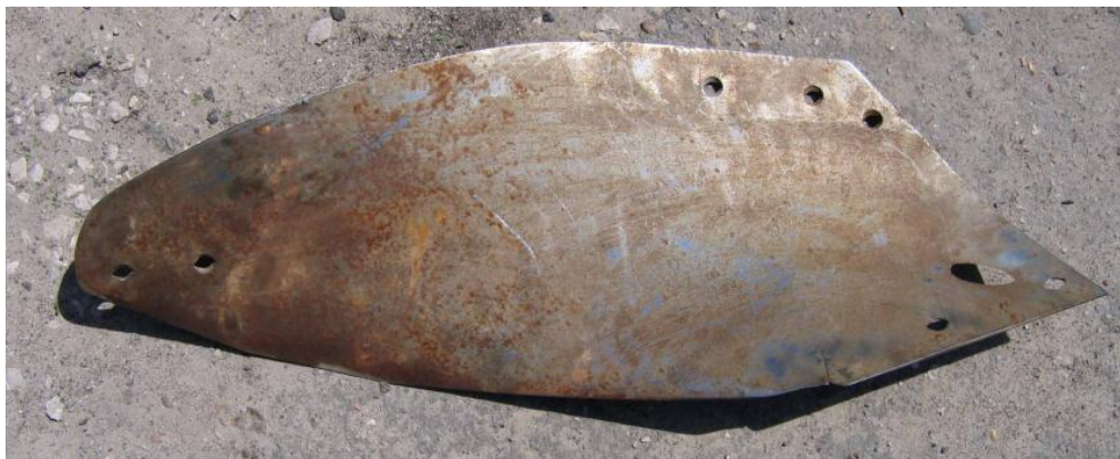
Рис. 1.2. Наскрізне зношування площини відвалу плуга Gregoire Besson
