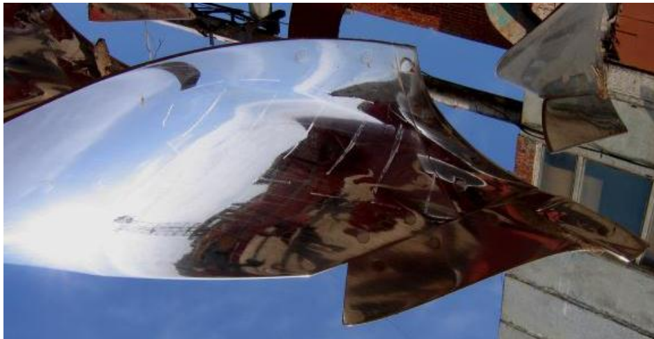
Рис. 3.1. Вид зношеного відвалу (крейдою штриховою лінією обведена зона найбільшого зношування грудей відвалу)
