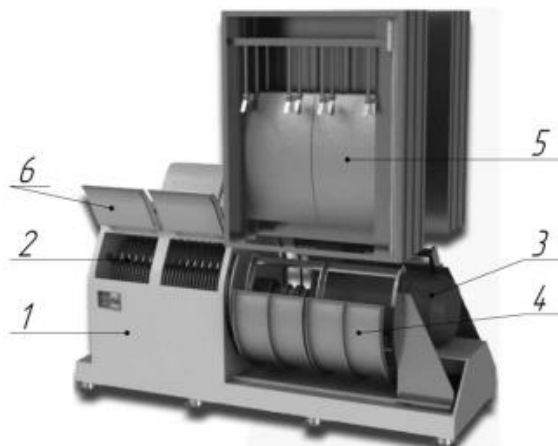
Рис. 1.5. Молоткова дробарка: 1 – корпус дробильної камери; 2 – молотковий ротор; 3 – електродвигун; 4 – змінне решето; 5 – шафа зі змінним решетом; 6 – кришка оглядового люка.
