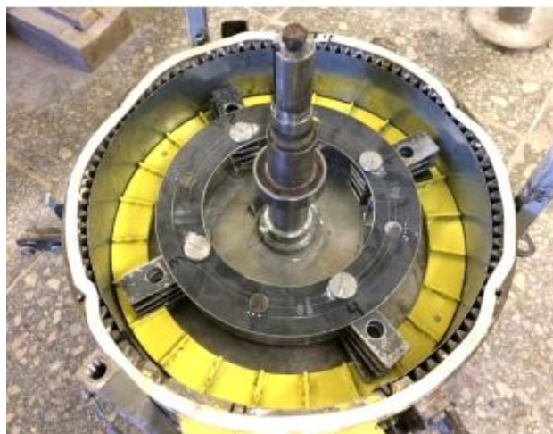
Рисунок 3.2. Загальний вигляд дробильної камери лабораторної установки з робочими органами
