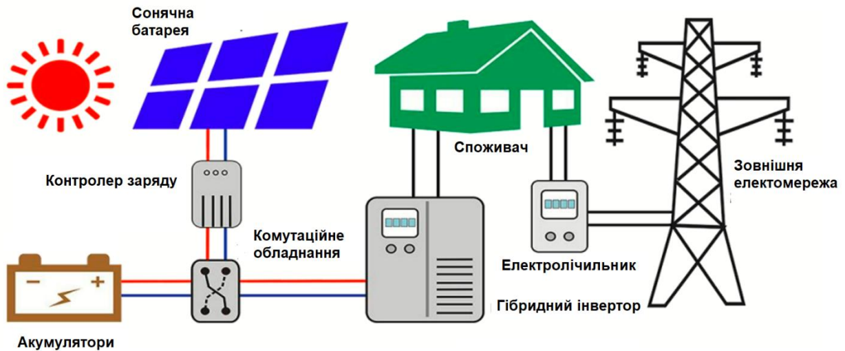
Рис. 1.3. Схема автономної, з'єднаної з мережею (гібридною) СЕС
