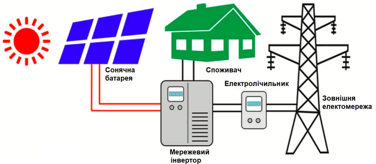
Рис. 1.2. Схема мережевої сонячної електростанції
