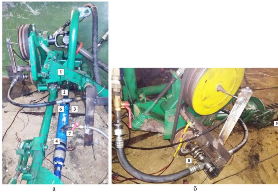
Рис. 2.2. Вид з боку ножа (а) та з боку приводних шківів (б) модернізованої конструкції приводу сегментно-пальцевої косарки КС-2,1: 1 – кривошип; 2 – шатун; 3 – гідроциліндр; 4 – шток; 5 – ніж; 6 – штуцер для підведення оливи; 7 – штуцер для подачі повітря; 8 – ударний вузол
