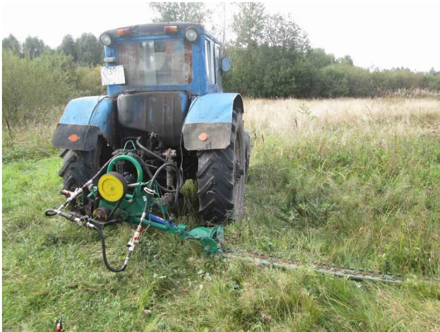
Рис. 2.3. Трактор із косаркою, яка оснащена гідроприводом ножа
