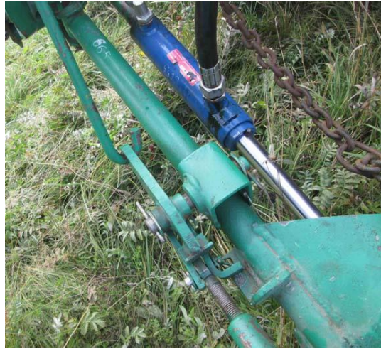
Рис. 2.6. Загальний вигляд гідроциліндра MC50/30×160
