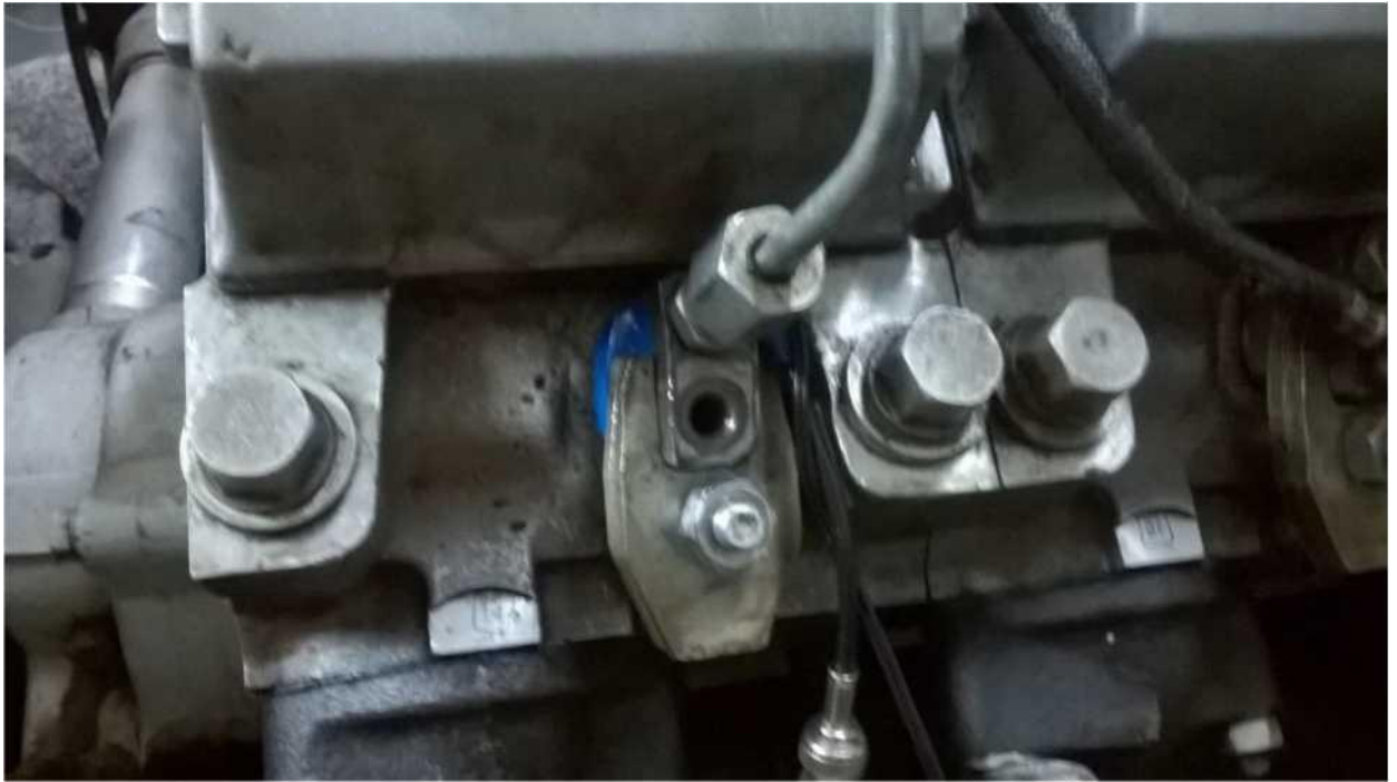
Рис. 2.2. Розміщення пристрою на дизелі у лабораторних умовах
