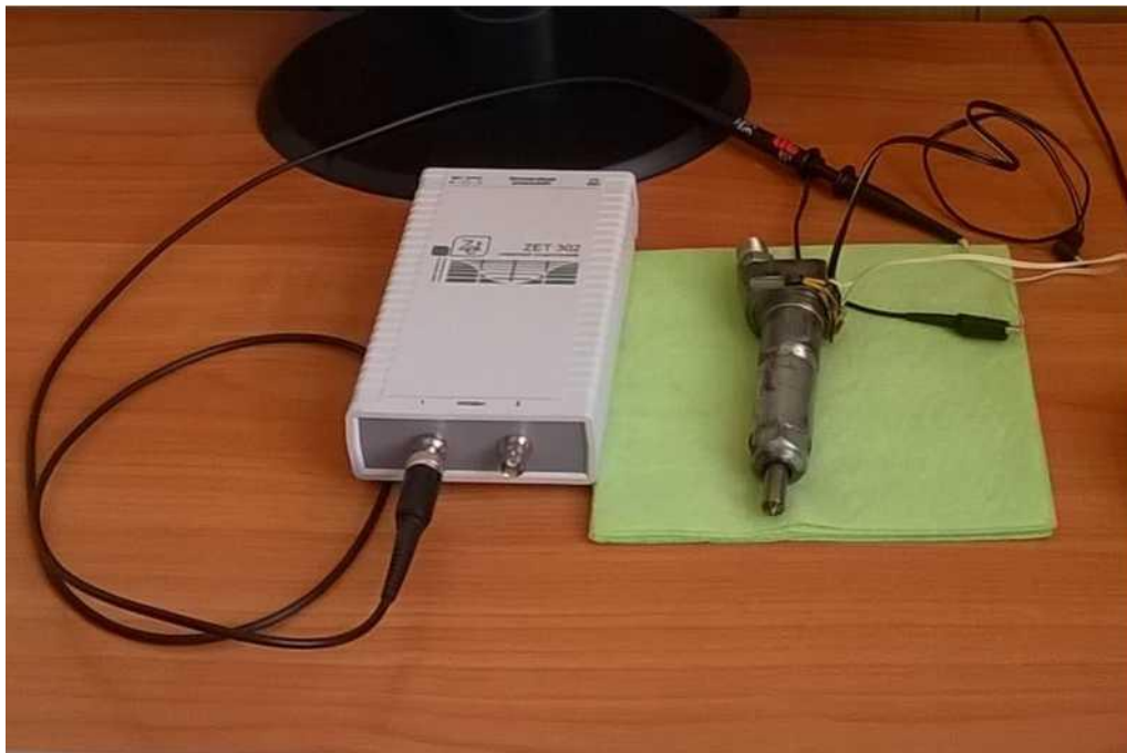
Рис. 2.1. Пристрій діагностування ПА дизеля: Ліворуч – цифровий осцилограф, праворуч – форсунка дизельного двигуна з датчиком переміщення голки
