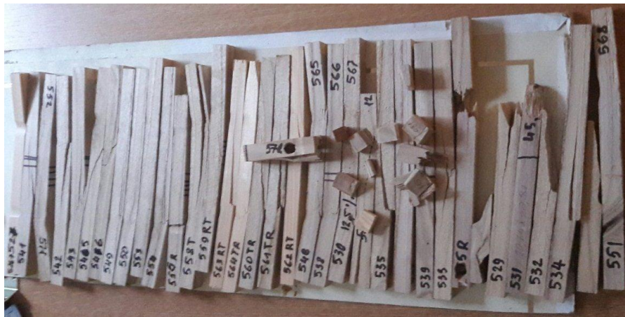
Рис. 7. Зразки, що пройшли випробування на чотириточковий вигин
