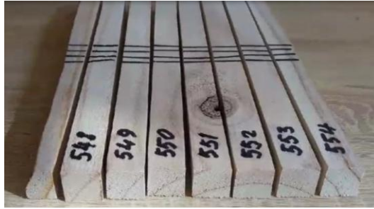
Рис. 1. Зразки розміром 300 x 20 x20 мм для стандартних випробувань на визначення межі міцності та модуля пружності при статичному згині.
