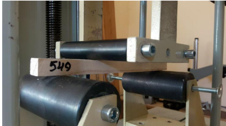
Рис. 6. Схема чотириточкового навантаження при дослідженні межі міцності та модуля пружності на розриній машині Р5-М2.
