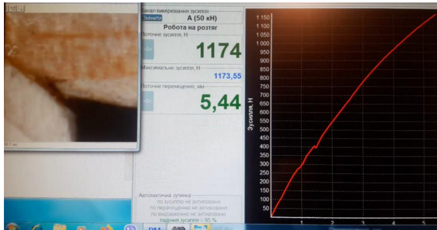
Рис. 3.13. Стан клейового шва в момент деформування-руйнування при навантаженні 1174 Н.
