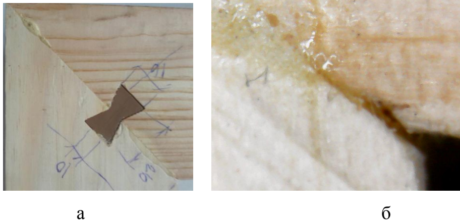
Рис. 3.12. а – загальний вигляд з'єднання (клей + Хофман); б – вихідний стан клейового шва в області максимальної напруги (за Мізесом)
