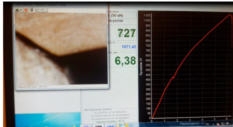
Рис. 3.8. Стан клейового шва в момент деформування-руйнування при навантаженні 727 Н.
