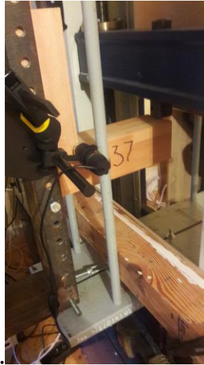
Рис. 3.4. Налагоджує програмно-апаратний комплекс. Видна рухома траверса розривної машини, цифровий мікроскоп в місці максимальної внутрішньої напруги клейового шва і зразок, що випробовується.
