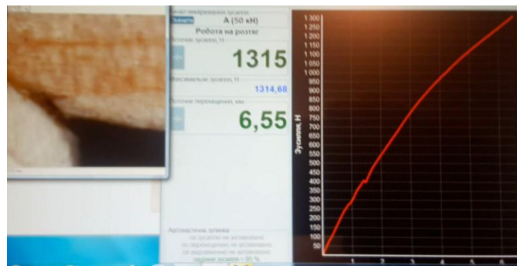
Рис. 3.14. Стан клейового шва в момент деформування-руйнування при максимальному навантаженні 1315 Н.
