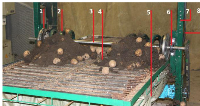
Рис. 2.1. Поперечний зворушувач з приводом: 1 – фланець; 2 – ворох; 3 – привідний вал; 4 – полотно елеватора; 5 – пакет для збору домішок; 6 – підшипник в корпусі; 7 – арка; 8 – провід живлення.
