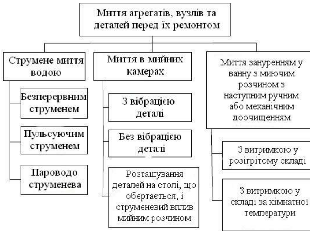
Рис. 1.2. Класифікація миття забруднених поверхонь агрегатів, вузлів та деталей під час ремонту машин.
