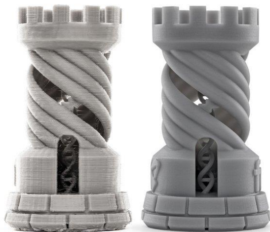
Рис. 14 макети створені за допомогою FDM та SLA технологій, товщина шару друку моделей — 0,1 мм.
