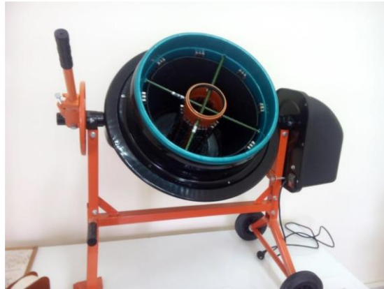
Рис. 3.3. Зовнішній вигляд експериментальної установки для дослідження параметрів та режимів магнітної установки з постійними неодимовими магнітами.
