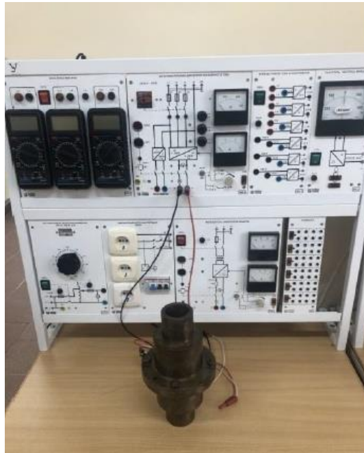
Рис. 3.2. Зовнішній вигляд експериментальної установки дослідження параметрів і режимів впливу постійним електромагнітним полем на картоплю.
