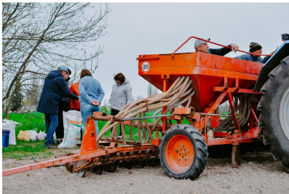
Рис. 5 Налаштування пневматичної сівалки на норму висіву (2,5 кг/га) Nigella sativa та підготовка органічних добрив Екоплант для сумісного внесення в рядок
