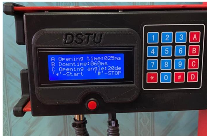
Рис. 3.5. Блок керування для регулювання робочих параметрів осцилюючого дозатора насіння
