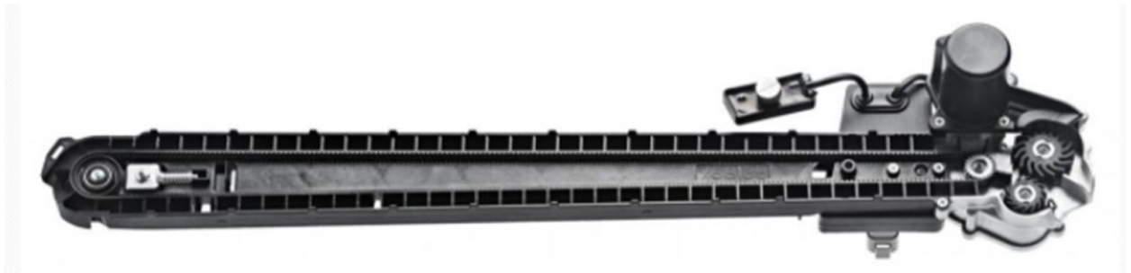
Рис. 1.6 . Сім'япровід елеваторного типу з механічним приводом
