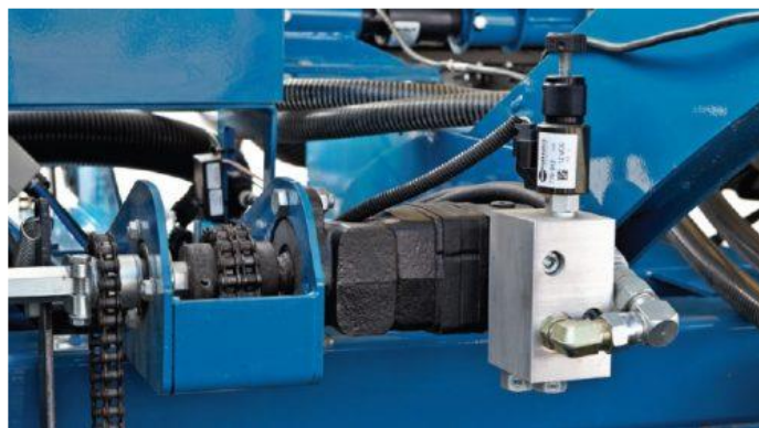
Рис. 1.5. Гідравлічний привід сівалок точного висіву фірми Kinze
