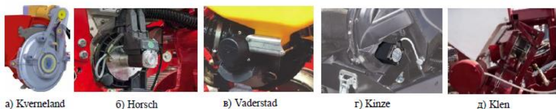
Рис. 1.4. Привід висівного апарату різних сівалок точного висіву від електродвигуна постійного струму
