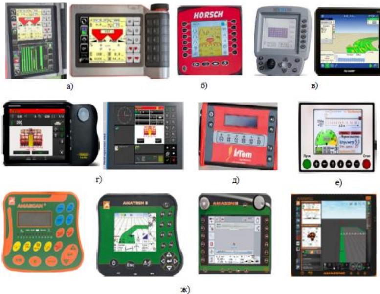
Рис. 1.9. Типи моніторів систем моніторингу висіву: а – IsoMatch Tellus Pro/GO (Kverneland); б – Horsch terminal; в – Kinze KPM III та ISOBUS display; г – Vaderstad E-control та ISOBUS terminal; д – Irtm screen; е – Klen монітор контролю висіву насіння; ж – AMASCAN+ та Amazone ISOBUS terminals (AMATRON 3, CCI 100 та AMAPAD)
