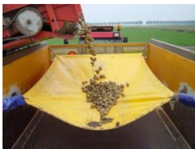
Рис. 1.6. Гасителі падіння бульб картоплі в кузові транспортного засобу.
