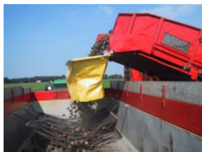
Рис. 1.6. Гасителі падіння бульб картоплі в кузові транспортного засобу.
