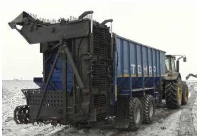
Рис. 1.4. Транспортний засіб, обладнаний вивантажувальним транспортером.
