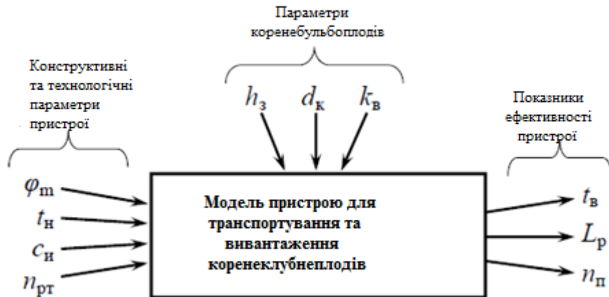
Рис. 3.1. Основні вхідні та вихідні параметри моделі пристрою для транспортування та вивантаження коренебульбоплодів
