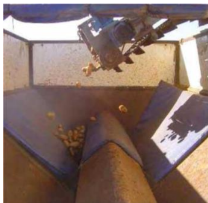
Рис. 1.5. Покриття прогумованим полотном захисного козирка, розташованого над вивантажувальним рухомим транспортером кузова транспортного засобу.
