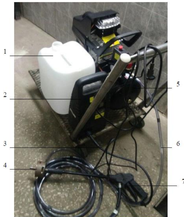
Рис. 3.5. Загальний вигляд установки: 1 – ємність для води, 2 – насос високого тиску, 3 – напірний шланг високого тиску, 4 – експериментальне сопло, 5 – компресор, 6 – повітряний шланг, 7 – манометр мийної установки,.
