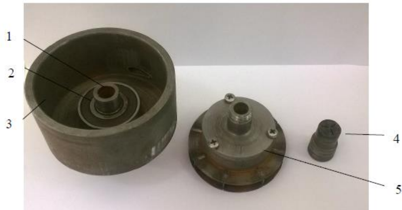
Рис. 3.3. Загальний вигляд пристрою для створення обертового гідравлічного струменя : 1 – нерухома труба, 2 – поворотна опора, 3 – корпус повітряної камери, 4 – віялоутворювальний гідравлічний насадок, 5 – ведене колесо з крильчаткою
