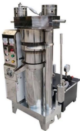
Рис. 1.1. Загальний вигляд гідравлічного преса Akita jr AKJP-900
