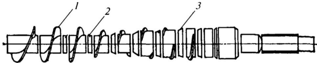
Рис. 1.3. Збірний шнековий вал преса: 1 – окремий збірний виток шнека; 2 – циліндричне проміжне кільце; 3 – конічне проміжне кільце
