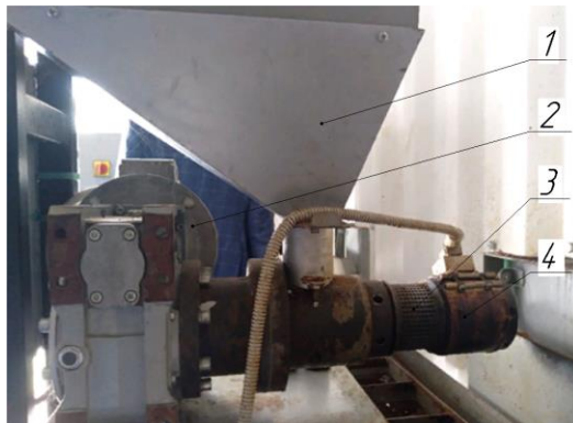
Рис. 3.3. Загальний вигляд експериментальної установки: 1 – приймальний бункер зі встановленим усередині магнетроном для нагрівання біомаси; 2 – електропривід; 3 – зерна камера; 4 – нагрівальний елемент для підтримання температури преса.
