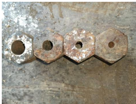
Рис. 3.4. Змінні штуцери зі змінним діаметром для виходу макухи.
