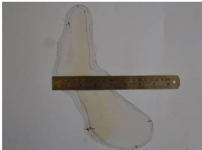
Рис. 2.2. Фрагмент вимірювання розміру плями в горизонтальному напрямку лінійкою: (ПММ – свіже моторне мастило) [20].
