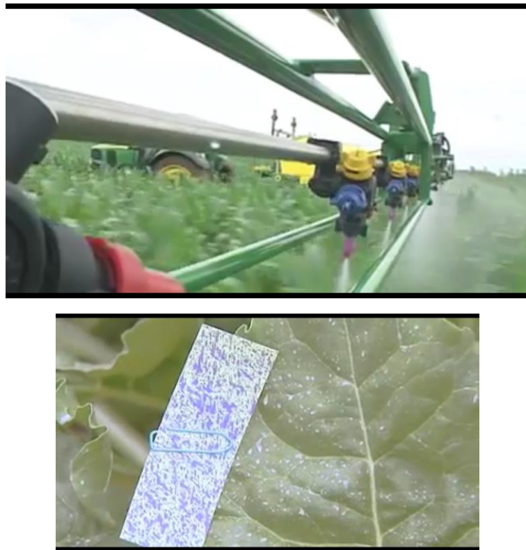
Рис. 3.1. Фото розпилення рідини на об'єкт обробки під час досліджень
