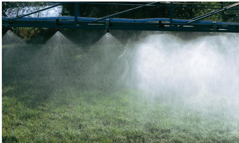
Рис. 1.1. Робота інжекторних розпльовачів (зліва) та щілинних (на фото праворуч)
