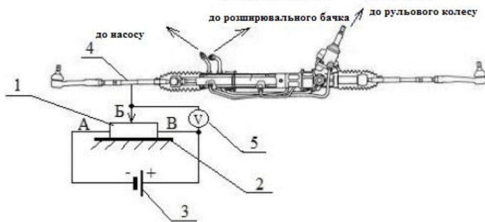
Рис. 3.3. Пристрій для контролю небажаних кутів повороту рульового колеса, обладнаного гідропідсилювачем
