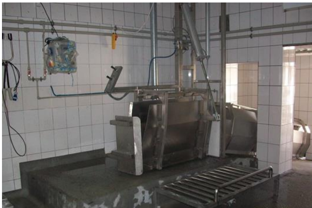
Рис. 3.5. Пневматичний бокс для оглушення тварин.
