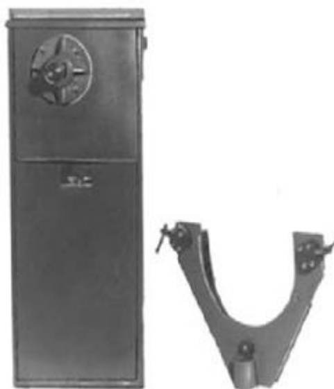
Рис. 4.2. стенд для ремонту редукторів Р-620.
