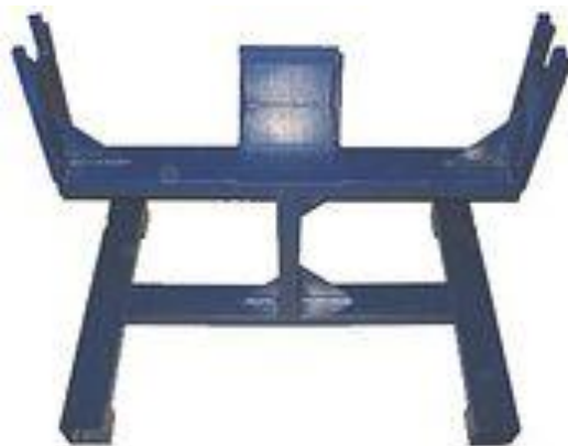
Рис. 4.1. Стенд моделі М-411 для розбирання складання заднього моста автомобілів.
