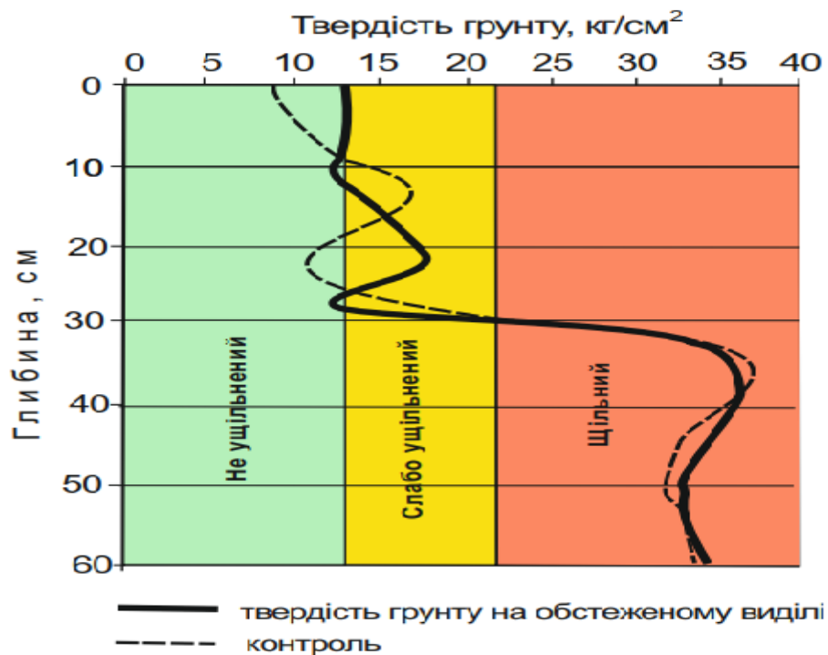
Рис. 12. Крива твердості ґрунту після проведених суцільно-санітарних рубок дубу звичайного ( Quercus robur L) (квартал 46, виділ 15 Поясківського лісництва) у порівнянні з контролем
