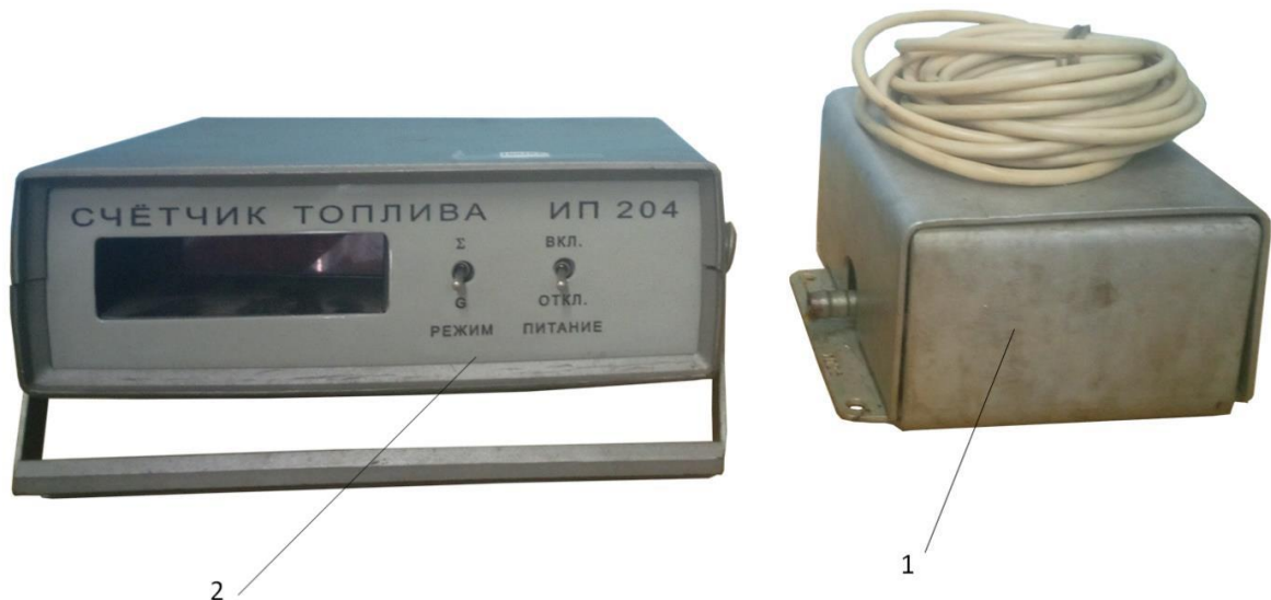
Рис. 1.12. Однопоточковий витратомір палива: 1 – датчик витратоміра; 2 – електронний блок реєстрації сигналів датчика [2, 7, 12].
