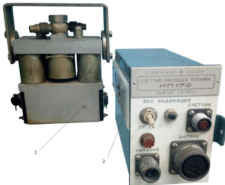
Рис. 1.11. Однопотоковый витратомір палива: 1 – датчик витратоміра; 2 – електронний блок реєстрації сигналів датчика.
