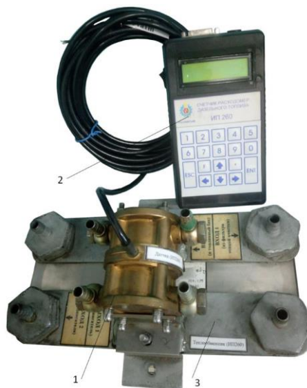
Рис. 1.13. Двопоточковий диференційний витратомір палива: 1 – датчик витратоміра; 2 – електронний блок реєстрації сигналів датчика; 3 – теплообмінник.
