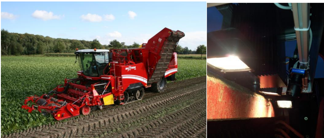
Рис. 3.2. Бурякозбиральний комбайн Grimme Maxtron 620 (ліворуч), реалізація HSI-системи над конвеєрною стрічкою на комбайні (праворуч)
