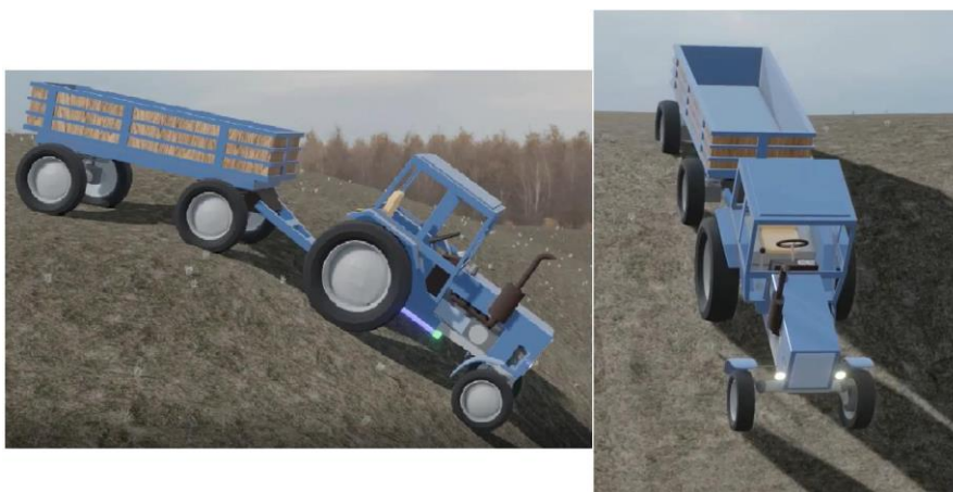
Рис. 2.10. Фрагменти емуляції руху експериментального ТТА на спуску
