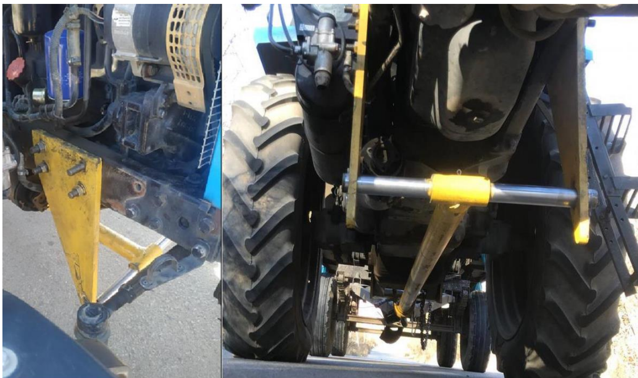
Рис. 2.24. Кутові кронштейни, встановлені на тракторі.
