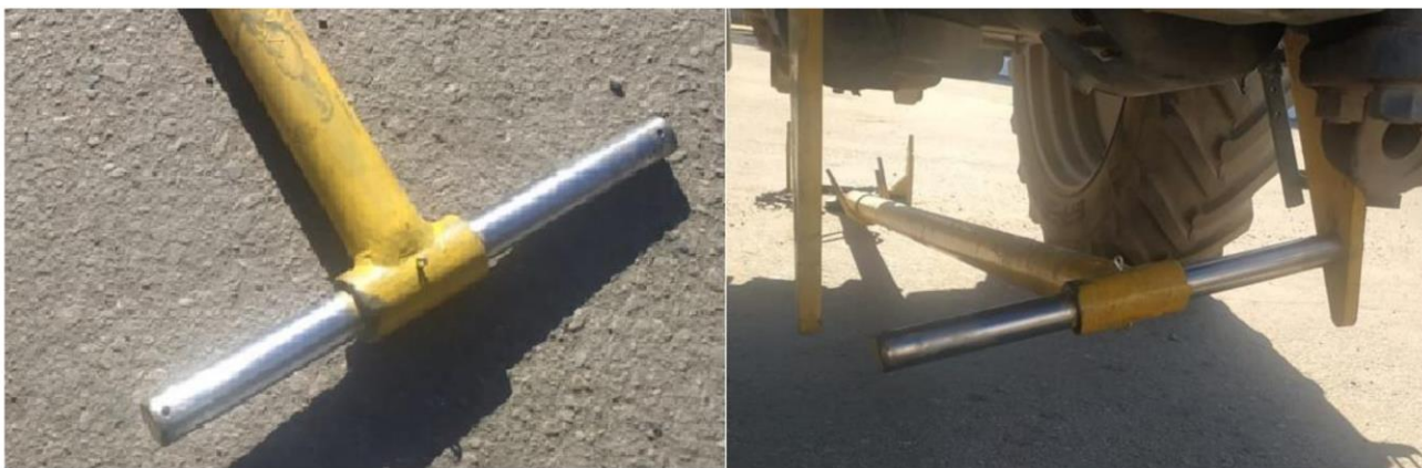
Рис. 2.22. Торсіонна вісь у процесі складання конструкції.
