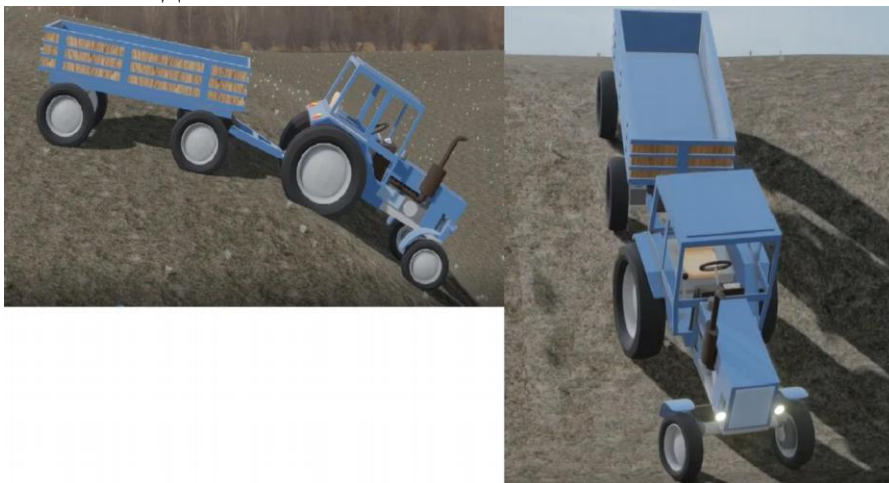
Рис. 2.7. Фрагменти емуляції руху експериментального ТТА на спуску.
