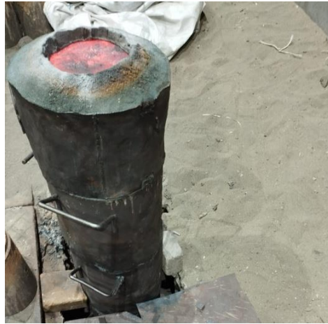
Рис. 3.9. Відливання електродів відкритої індукційної виплавки
