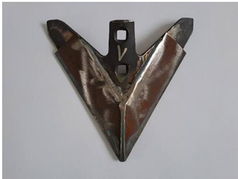
Рис. 2.7. Виготовлена лапа культиватора КРН-220.
