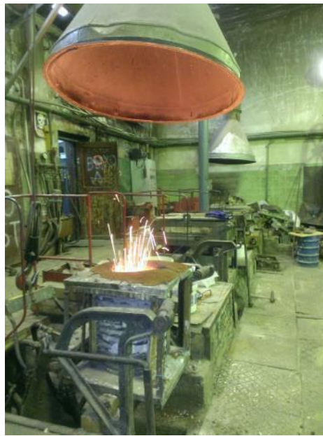
Рис. 3.8 Процес виплавки сталі у відкритій індукційній печі ІСТ 016
