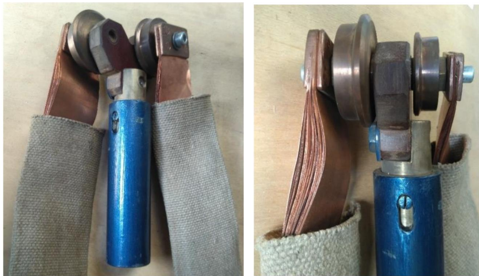
Рис. 2.4. Державка телескопічна та її кріплення з інструментальним роликом у різцетримачі токарно-гвинторізного верстата [20].
