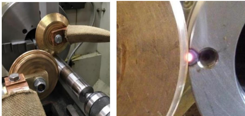
Рис. 1.7. Процес ЕМПЗ на токарному верстаті
