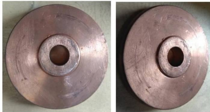
Рис. 2.5. Загальний вигляд інструментального ролика [20].
