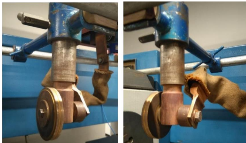
Рис. 2.3. Загальний вигляд і розташування струмопідвідного пристрою на токарно-гвинторізному верстаті [20].
