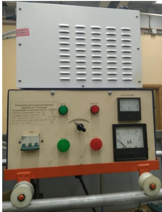
Рис. 2.2. Установка электромеханического поверхностного закаливания [20].
