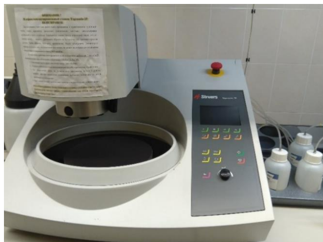
Рис. 2.10. Шліфування та полірування мікрошліфів Tegramin-25
