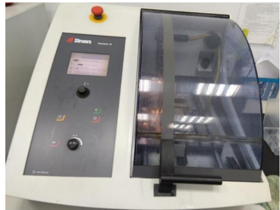
Рис. 2.8 Установка різання зразків Struers Secotom-15
