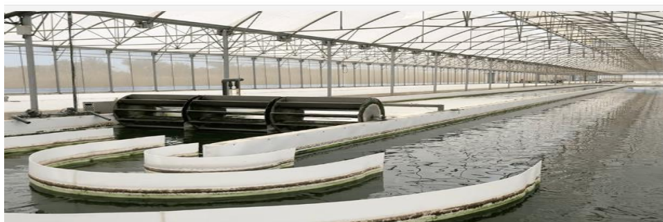
У концепції REALM системи доріжок будуються поруч із теплицями. У цих відкритих водоймах можна економно вирощувати мікродорості. Фото Biorizon Biotech.
