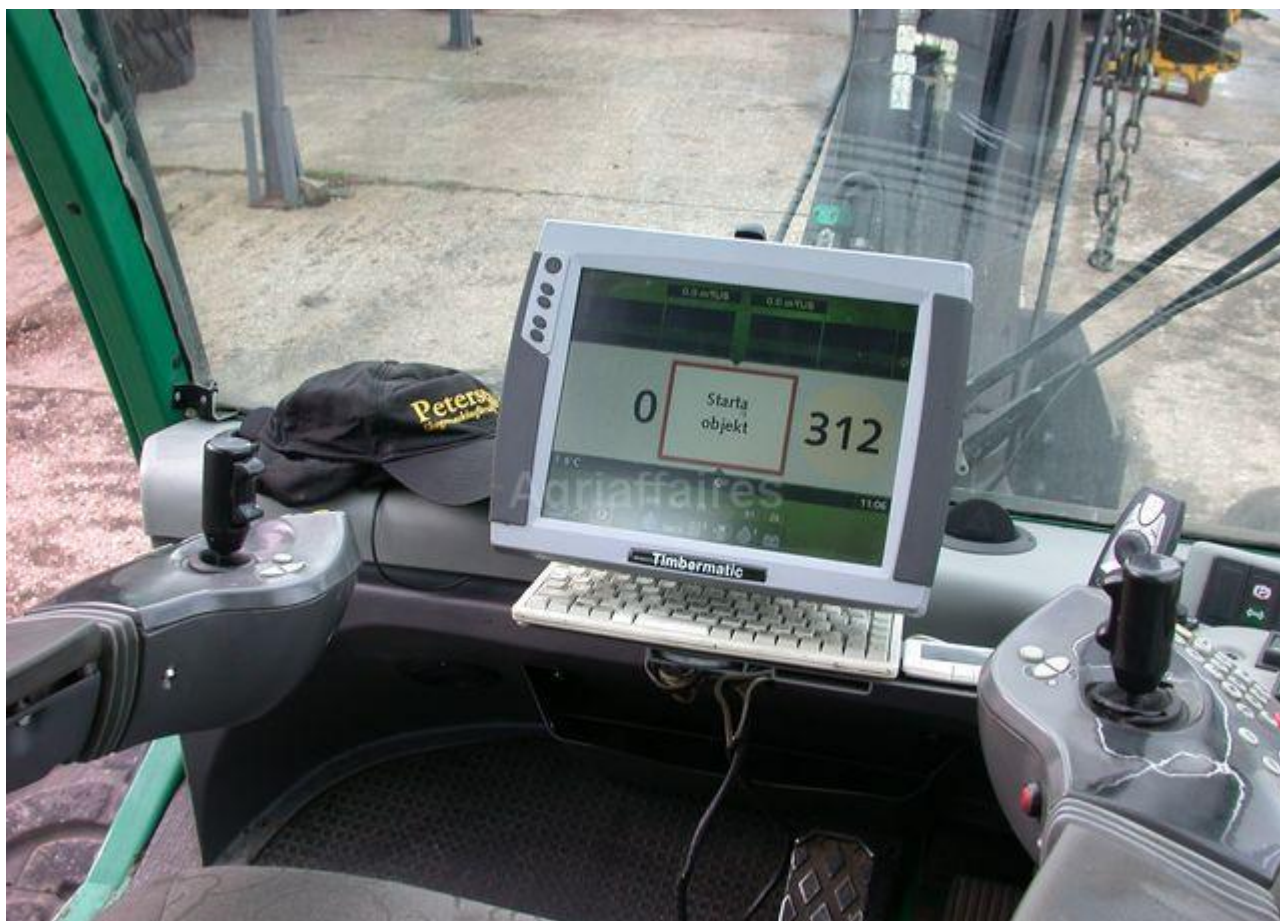
Рис. 3.3.3.10. Комп'ютеризована система управління роботою харвестера
