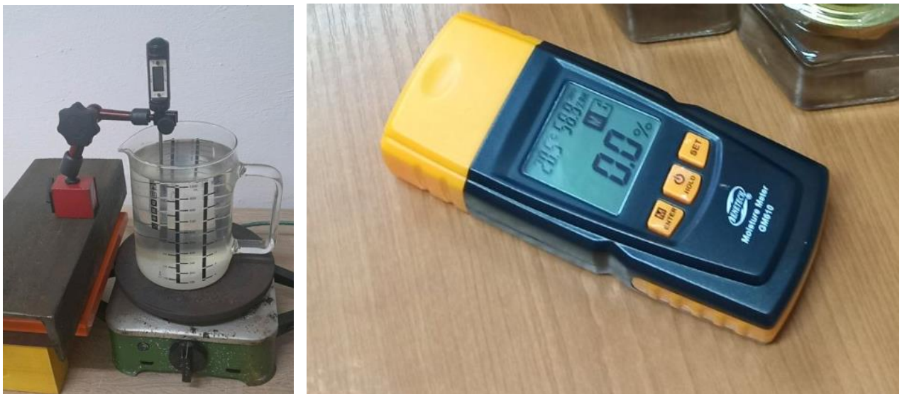
Рис. 8. Нагрівальний елемент, електроплитка; калорифер – кухоль зі спеціального скла; термометр і вологомір.
