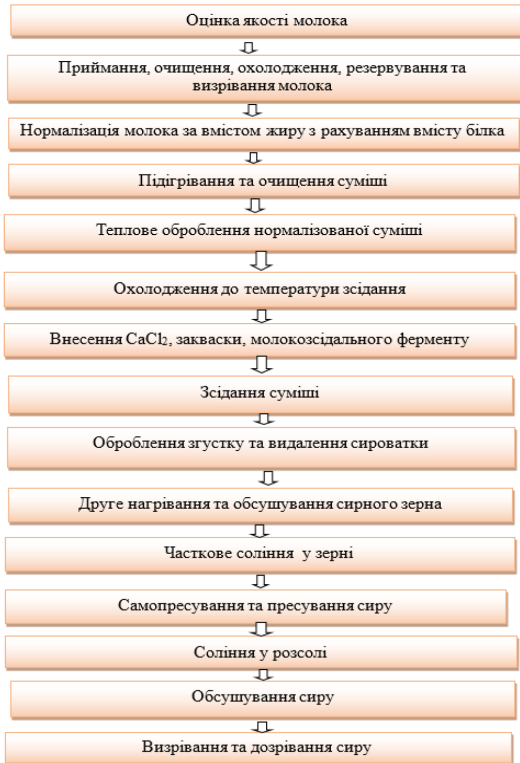
Рис. 3.18. Загальна технологічна схема виробництва сичужного сиру.
