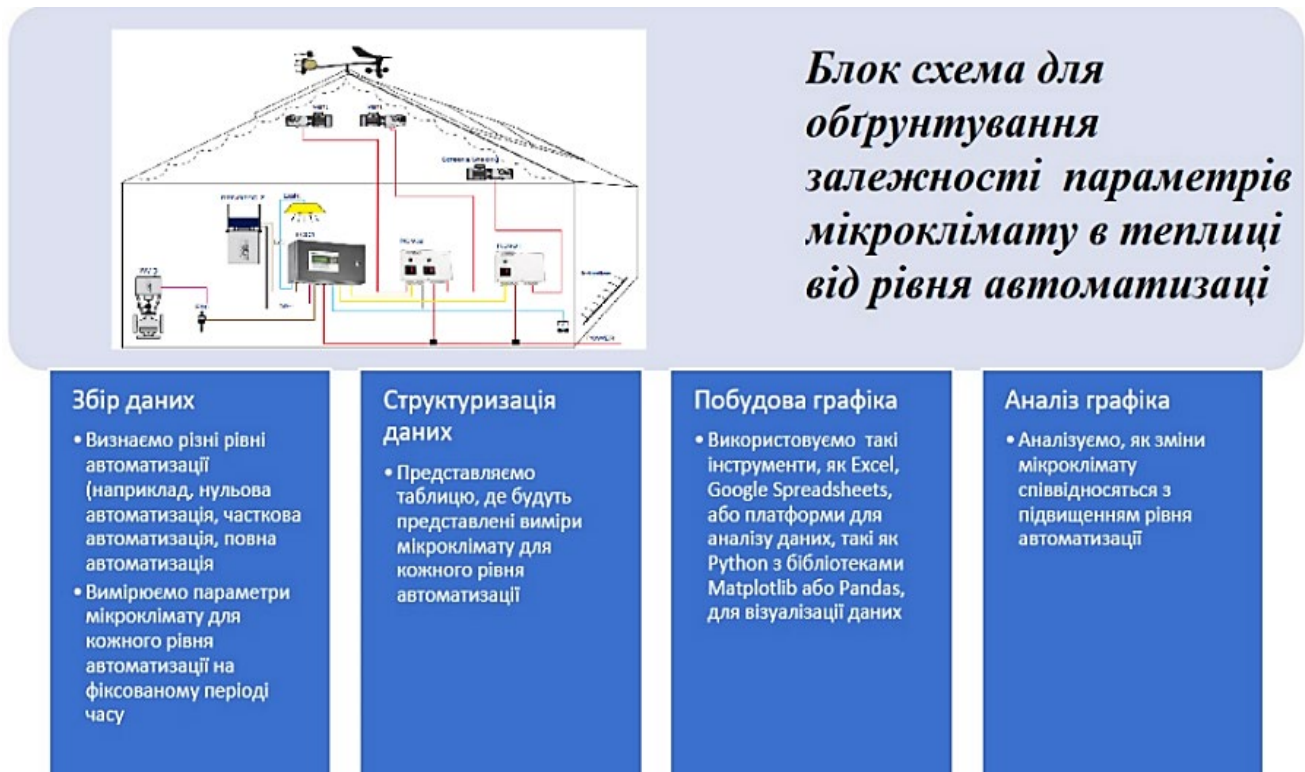
Рис.7. Блок схема залежності параметрів мікроклімату в теплиці від рівня автоматизації представлена [39]
