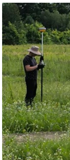
Рис. 6. Фіксація наземних контрольних точок (GCP) за допомогою RTK GNSS-приймача Hi-Target V30Plus
