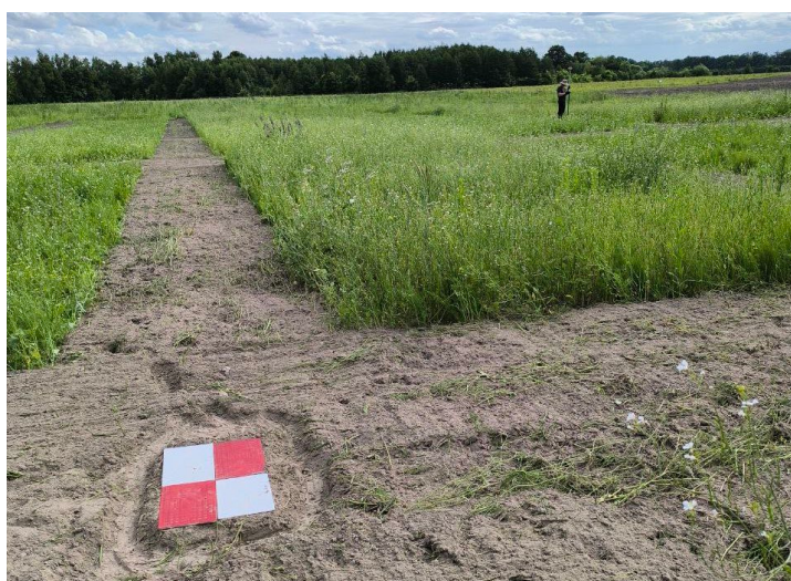
Рис. 6. Фіксація наземних контрольних точок (GCP) за допомогою RTK GNSS-приймача Hi-Target V30Plus
