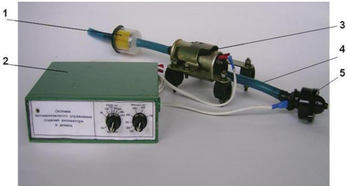
Рис. 1.5. Загальний вигляд системи одноточкового впорскування паливного активатора (найменування позицій у тексті)
