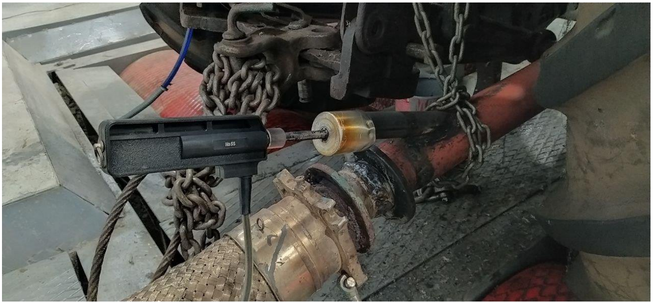
Рис. 2.11. Місце встановлення пробовідбірника газоаналізатора ГІАМ-29-М3 на стенді для тягових випробувань трактора з біговими барабанами
