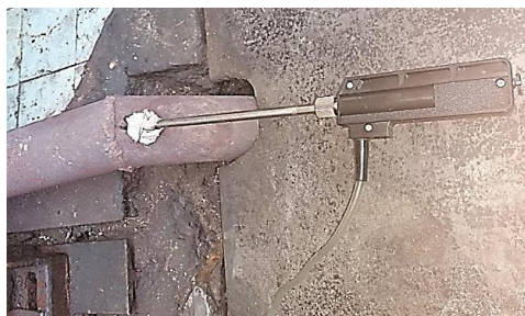
Рис. 2.9. Місце встановлення пробовідбірника газоаналізатора в системі відведення відпрацьованих газів дизеля
