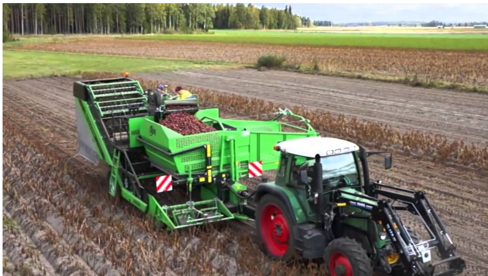
Рис. 1.4. Дворядний комбайн AVR Spirit 6200
