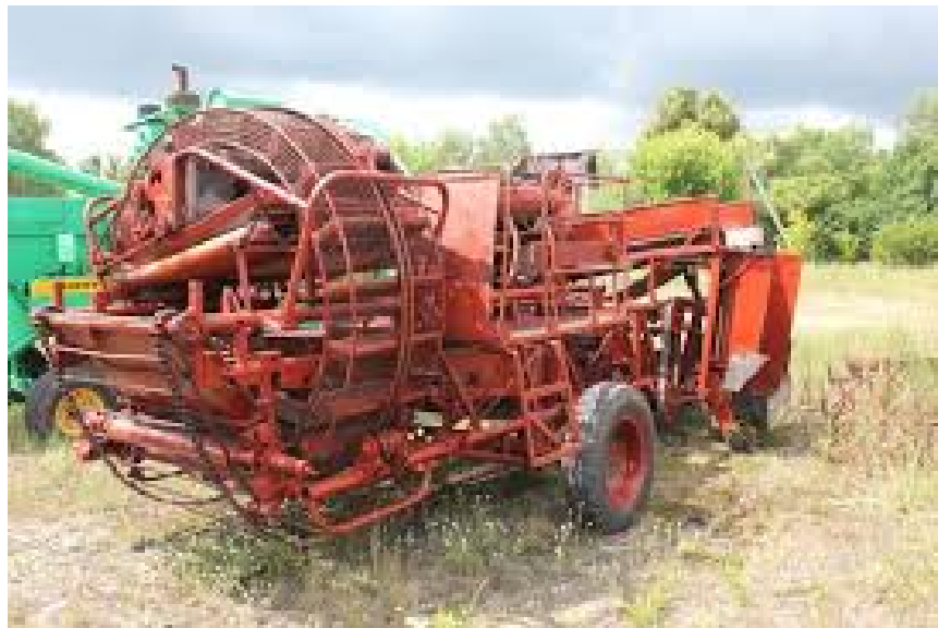
Рис. 1.3. Дворядний комбінований картоплекомбайн ККУ-2
