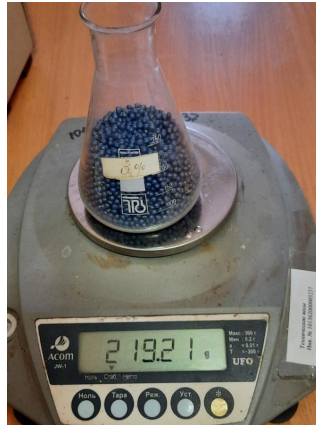
Рис. 2.8. Установка для визначення об'ємної маси насіння
