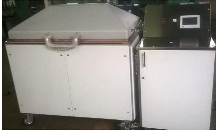
Рис. 2.3. Установка для створення соляного туману КСТ-18/001.
