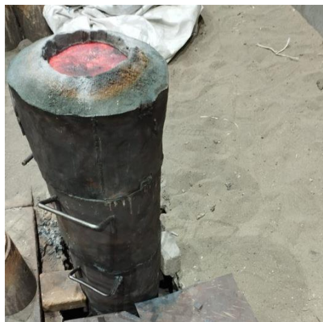
Рис. 3.9. Формування електродів після відкритої індукційної виплавки.
