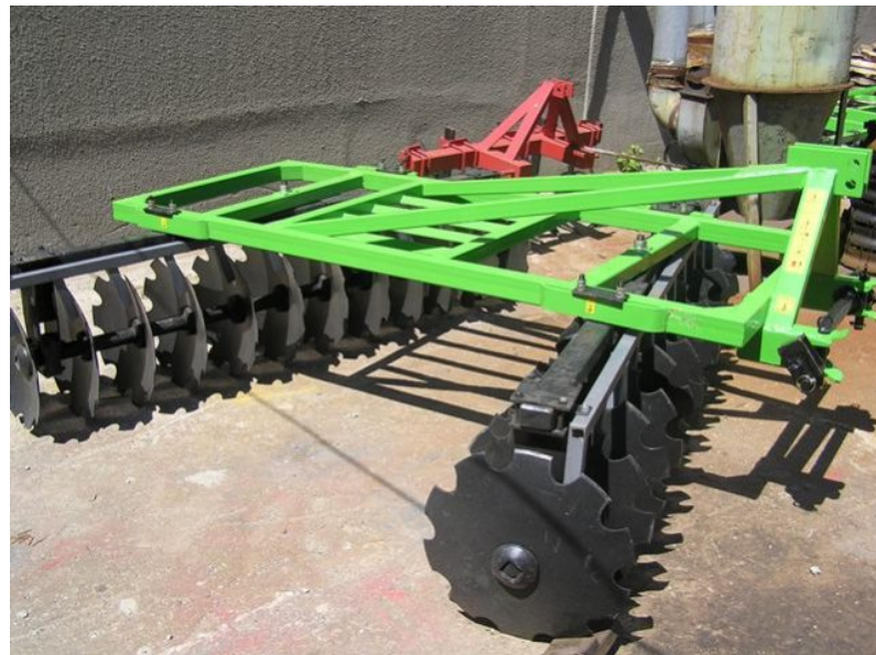
Рис. 1.2. Дискова борона (луцильник) навісного типу із секціями увігнутих дисків.
