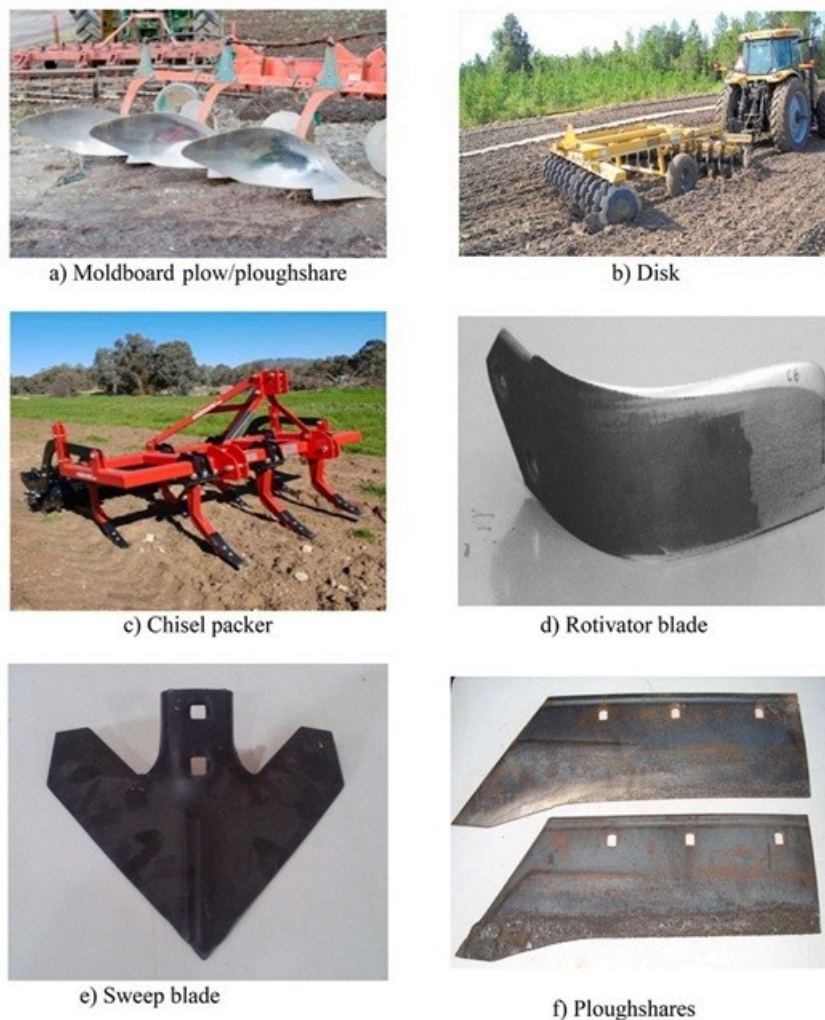
Рис. 1.3. Приклади ґрунтообробних робочих органів, що потребують зносостійкості: а) плуг, б) диск борони, с) долото культиватора, д) лемеш плуга, е) ротаційний ніж, ф) плужні лемеші (один із них із зношеним носком).
