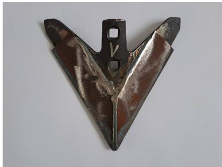
Рис. 2.7. Дослідна лапа культиватора КРН-220 після виготовлення.
