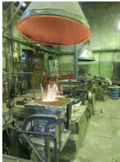
Рис. 3.8. Процес виплавлення сталі у відкритій індукційній печі
