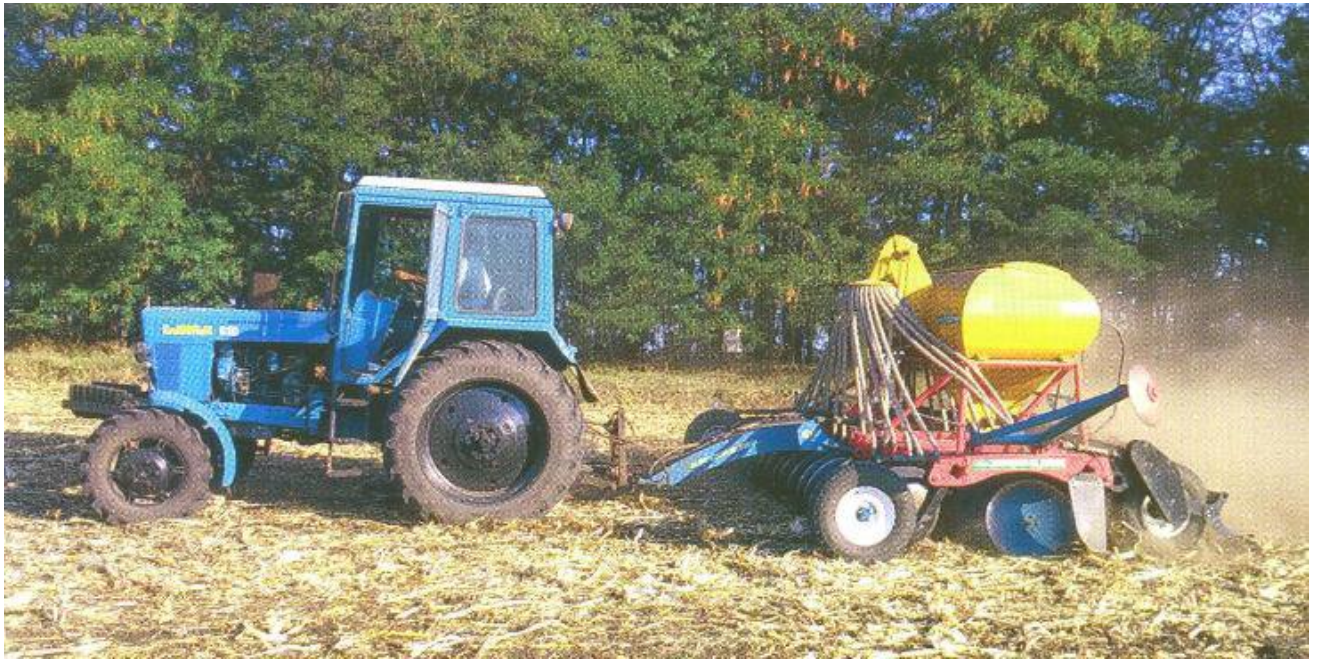
Рис. 3.2. Ґрунтообробно-посівний комплекс Р-4,2М у роботі
