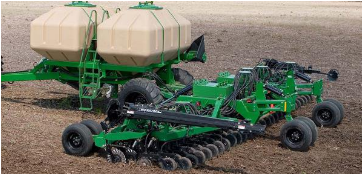
Рис. 1.5. Ґрунтообробно-посівний комплекс Great Plains NTA 3510 (США)
