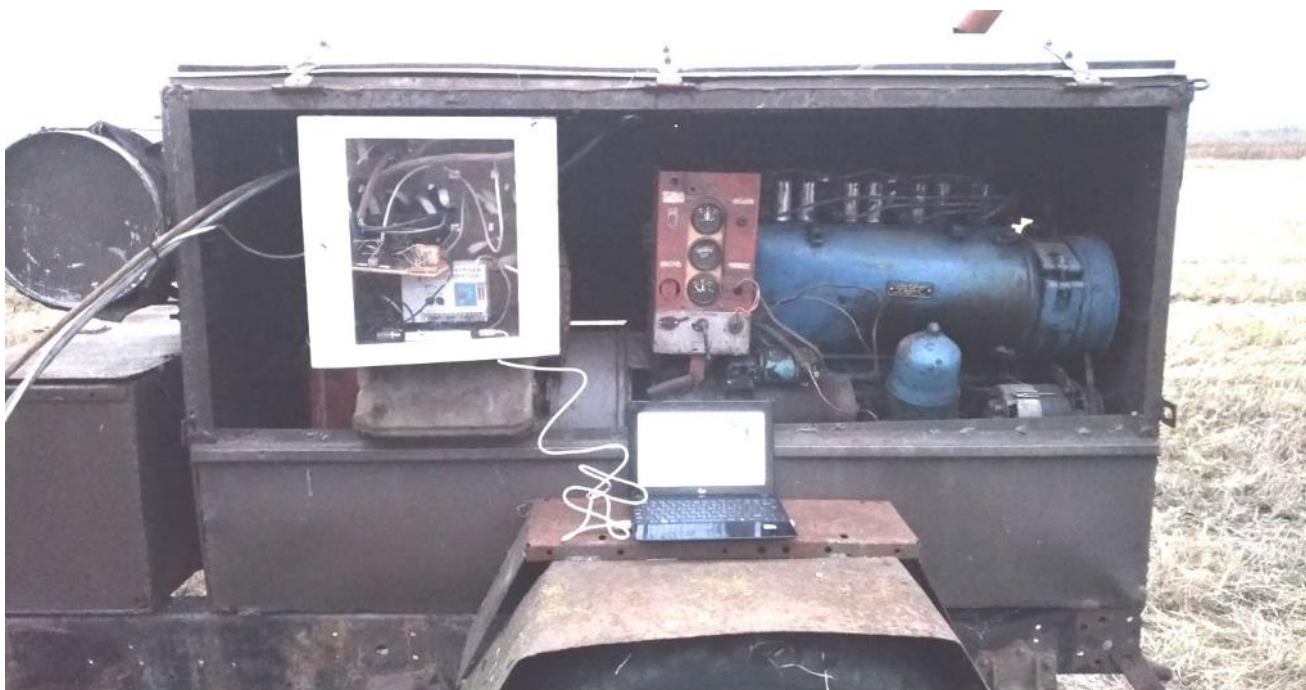
Рис. 3.10. Дизель-генератор і блок управління приводом ДРА
