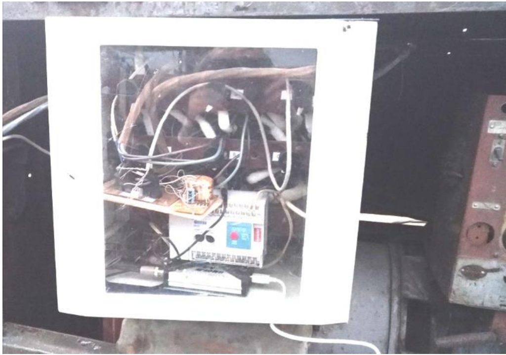
Рис. 3.11. Блок управління приводом ДРА з встановленими всередині АЦП і датчиками струму
