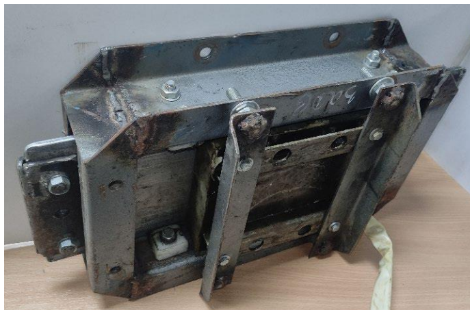
Рис. 3.4. Виготовлений ДПЛАД для привода ДРА жатки [1].
