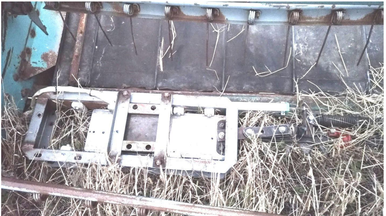
Рис. 3.12. Встановлений ДПЛАД з датчиком лінійного переміщення в приводі ДРА
