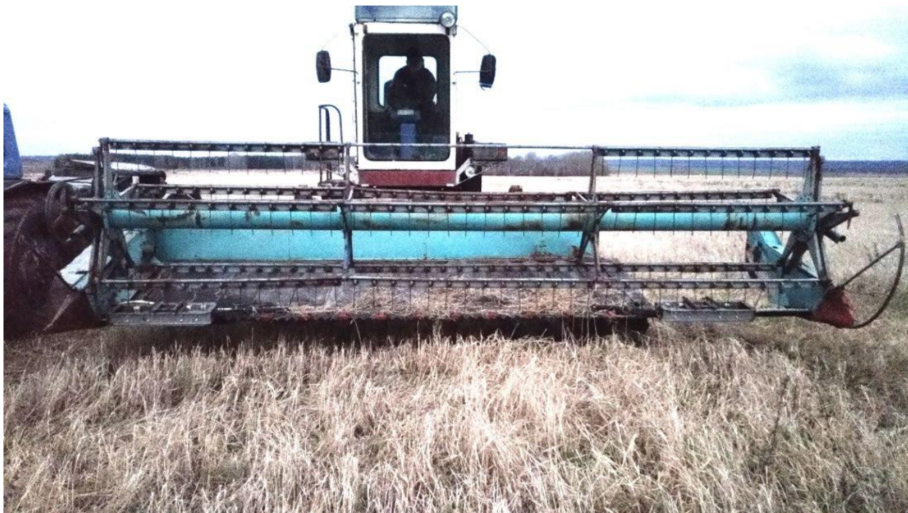
Рис. 3.9. Експериментальний зразок ДРА з приводом на основі ДПЛАД
