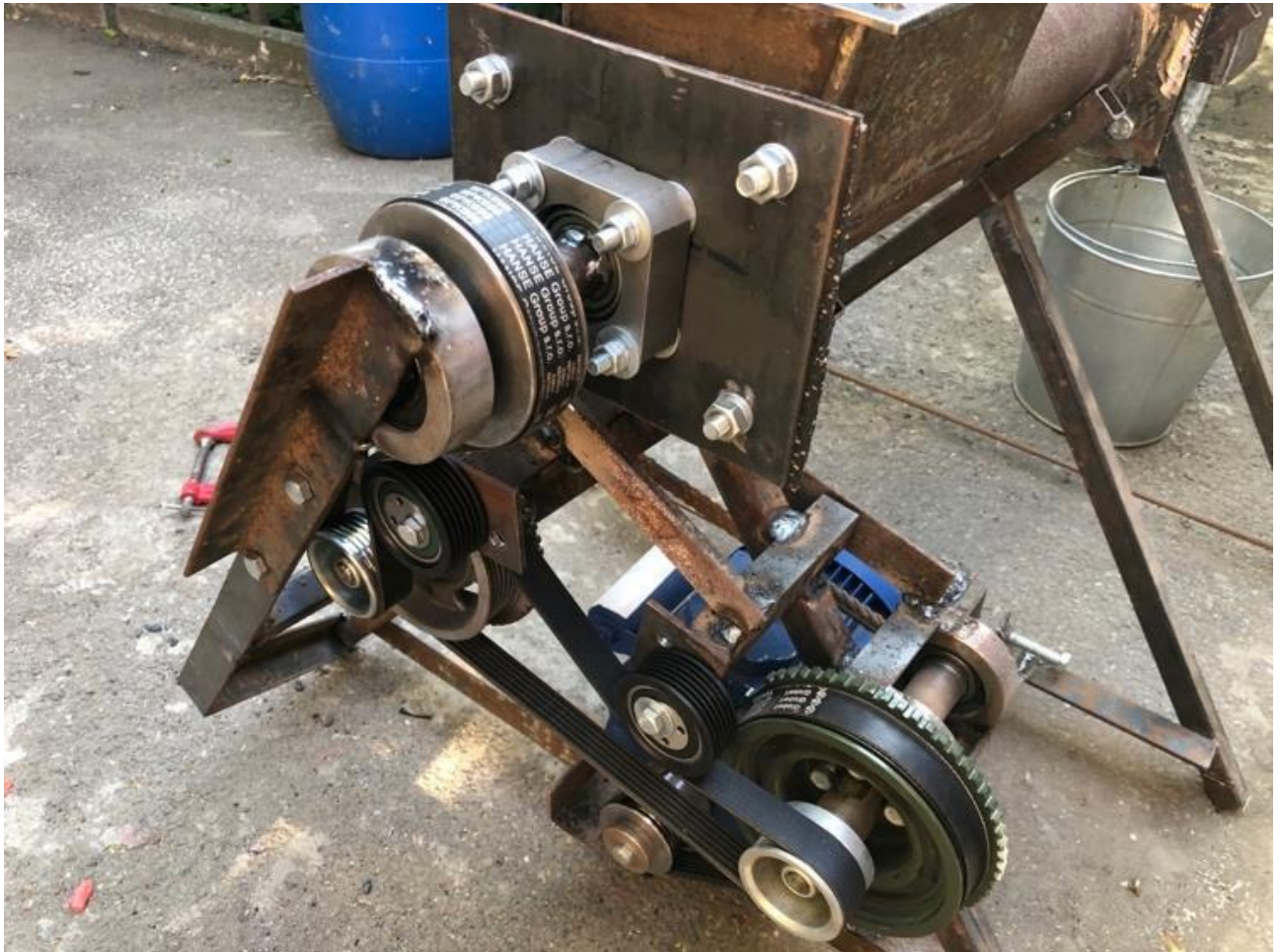
Рис. 2.5. Загальний вигляд привода змішувача [3].
