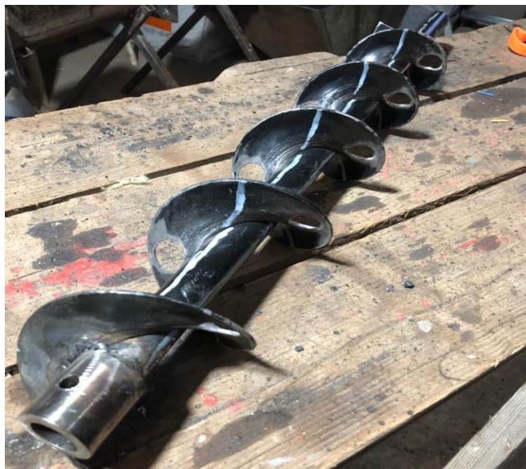
Рис. 2.4. Загальний вигляд шнекової мішалки з пересипними отворами [3].
