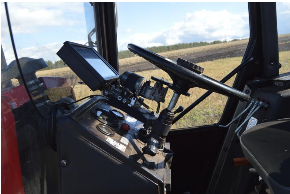
Рис. 2.9 Місце встановлення електронного блока керування з сенсорним дисплеєм.
