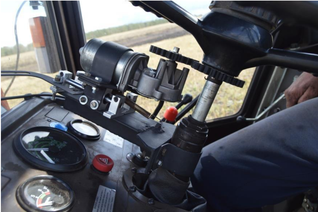
Рис. 2.8. Місце встановлення підрулювального пристрою.
