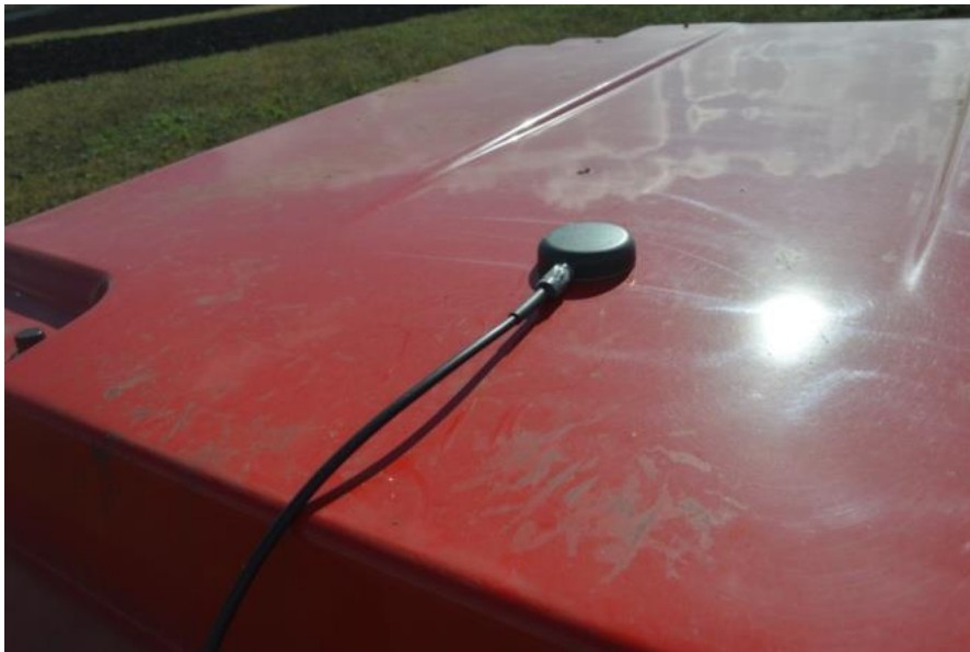
Рис. 2.11. Місце встановлення високоточної антени з магнітною основою
