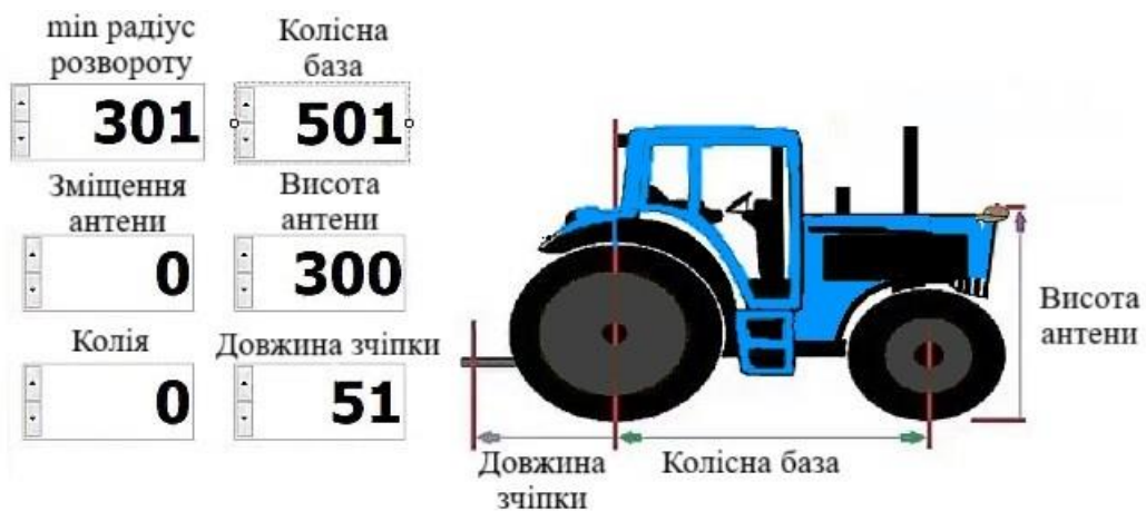
Рис. 2.13. Інтерфейс автоматичної системи керування МТА.
