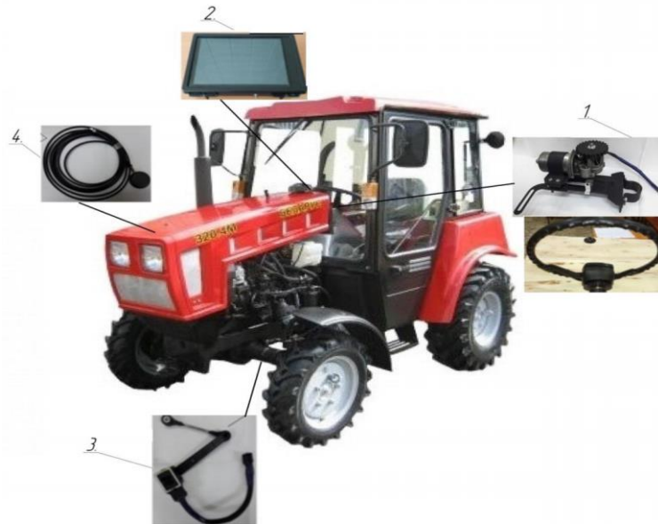
Рис. 2.7. Встановлювальний комплект автоматичної системи керування МТА з використанням GPS-навігації на тракторі Belarus-320.4
