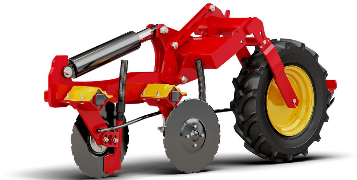
Рис. 1.2. Секція з однодисковим сошником сівалки Väderstad [2].
