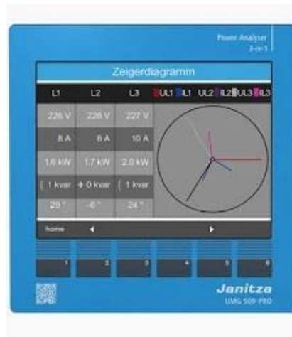
Рисунок 1.2 - Діагностичний комплекс «Janitza UMG 509-PRO»
