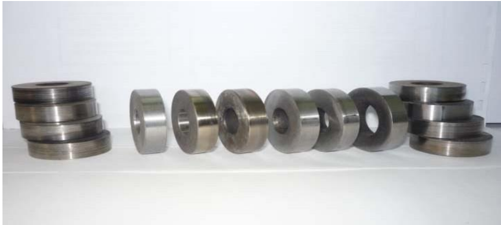
Рис. 2.10. Зразки для дослідження впливу трибоматеріалів у складі оливи на величину зносу.
