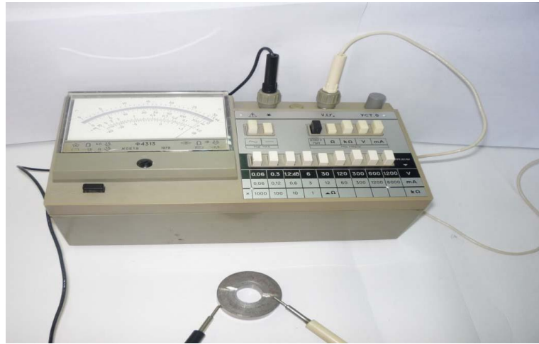
Рис. 2.14. Вимірювання електроопору антифрикційної плівки на зразку.
