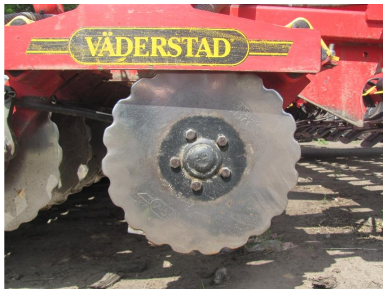
Рис. 3.4 Зовнішній вигляд Väderstad Rapid A 800 C: внутрішня поверхня (а) та зовнішня поверхня (б).
