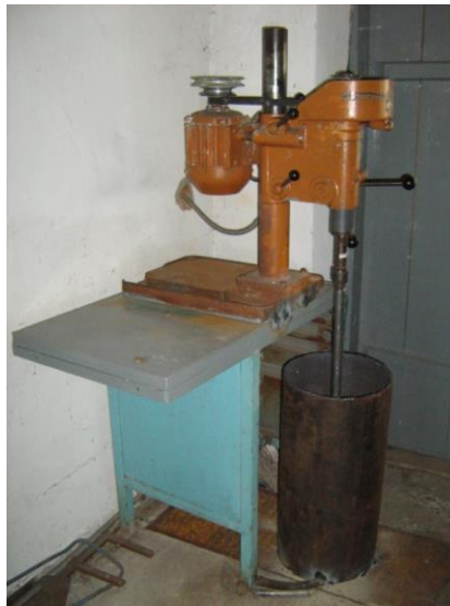
Рис. 2.2. Експериментальна установка для визначення стійкості матеріалів та зносостійких покриттів до абразивного зношування.
