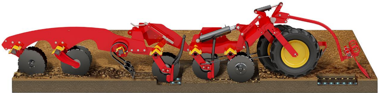
Рис. 2.1. Конструктивно-технологічна схема посівного комплексу Väderstad Rapid A 800 C.
