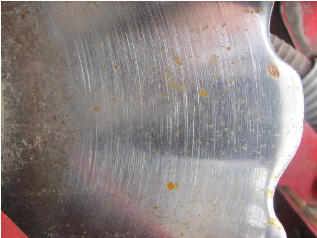
Рис. 3.7. Характерні ознаки мікрорізання робочої поверхні під дією ґрунтових абразивів.
