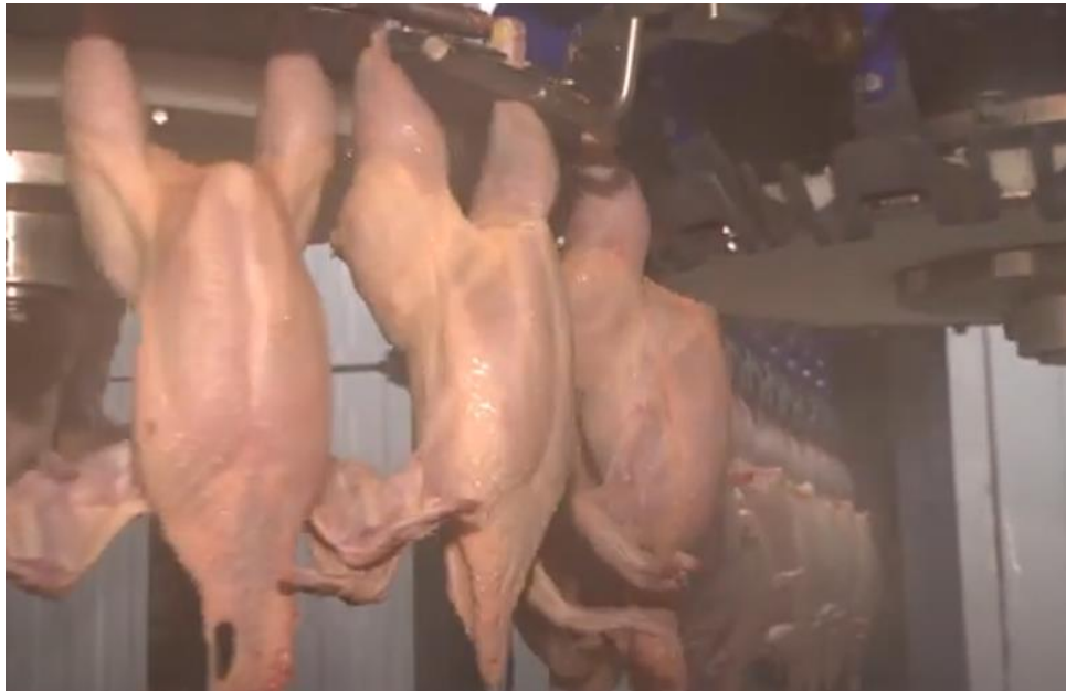
Рис. 3.8. Охолодження тушок птиці в повітряно-крапельній камері
