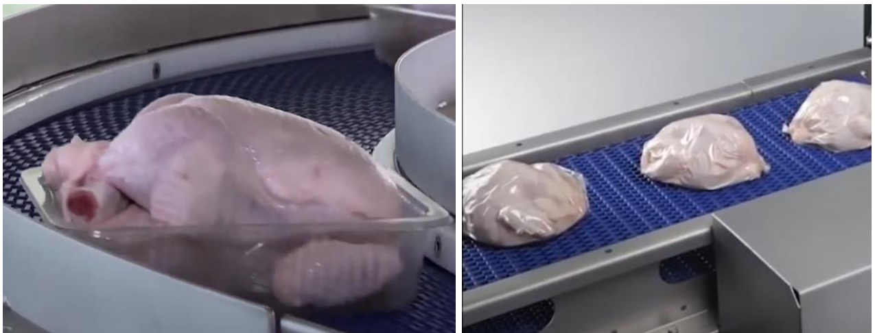
Рис. 3.9–3.10. Транспортування фасованих тушок птиці на пакування
