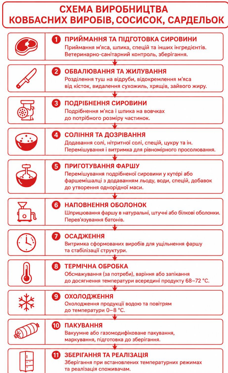
Рис. 5. Схема технологічного процесу виробництва ковбасних виробів, сосисок, сардельок у ТОВ «ТД «Мар'ян»
