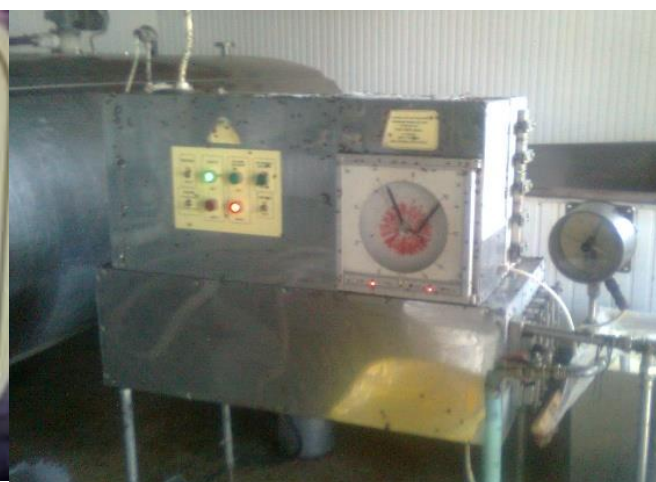
Рис.6-7. Установа для пастеризації та знезаражування молока
