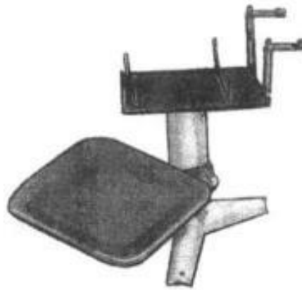
Рис. 3.1. Стенд Р-201 для виконання операцій розбирання та складання коробок передач.
